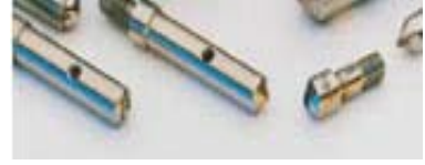
Resim3.2: Vickers sertliğinde kullanılan batıcı uç çeşidi
