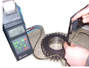
Resim 4.4: Cam boruyu malzeme yüzeyine yerleştirme ve çekiççiği bırakma
