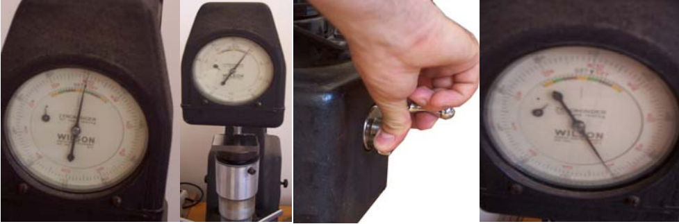
Resim 2.4: Sertlik değerini cihazdan okuma aşamaları.(Ön ve ana yükün uygulanması, ana yükün kaldırılması ve değerin okunması)
