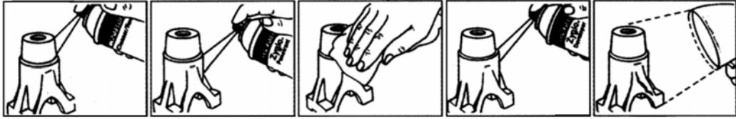
Şekil 1.1: Ultraviyole ışınları altında sıvı emdirerek yapılan muayenenin aşamaları
