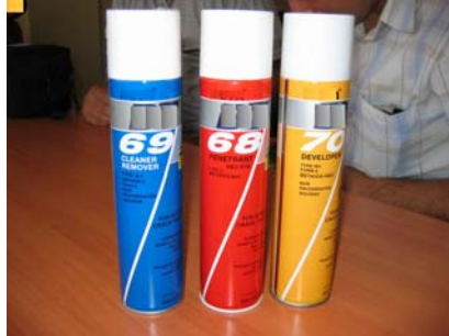
Resim 1.1: Penetran testinde kullanılan soldan sağa doğru temizleyici sprej , penetran sprej ve geliştirici sprej
