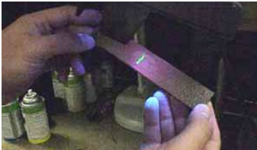
Resim 1.4: Flüoresan penetran (girici) sıvıyla ultraviyole ışınları altında yapılan test resimleri
